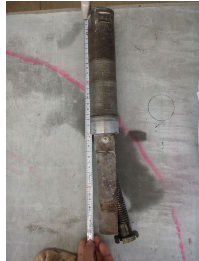
写真—1 孔内溝切装置
